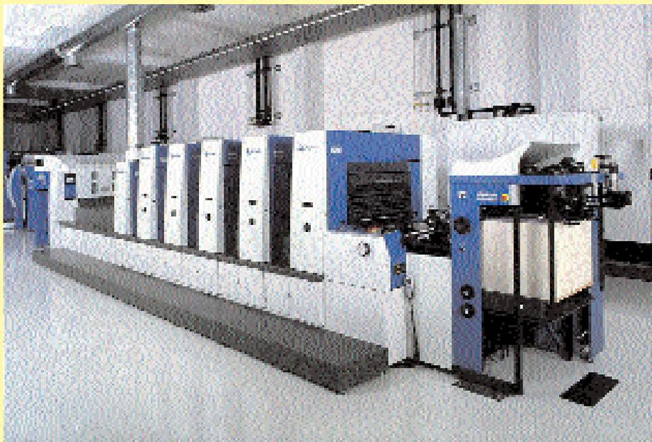
Abbildung 1: Eine solche Bogenoffset-Druckmaschine (KBA Fünffarben-Rapida 74 mit Lackturm und Auslageverlängerung) war vom Mattlack in Mitleidenschaft gezogen worden.
